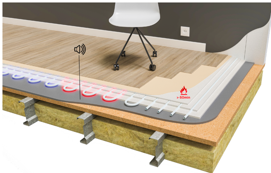
Vloerverwarming en koeling
